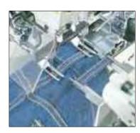
Figure 10.5: Belt Loop Automaton (www.astasjuki.com)
